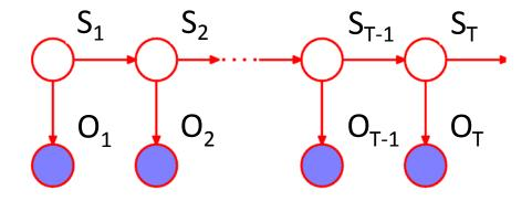
$$p(\{S_t\}_{t=1}^T, \{O_t\}_{t=1}^T) = p(S_1) \prod_{t=2}^T p(S_t|S_{t-1}) \prod_{t=1}^T p(O_t|S_t)$$
